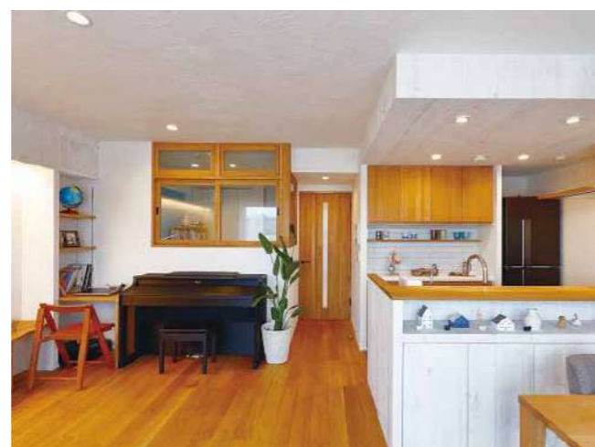
連段窓：FIX窓+引違窓 樹種：アッシュ カラー：L16（ナチュラルオーク） 金物：標準（ブラック） ガラス：A-5（透明ガラス）
